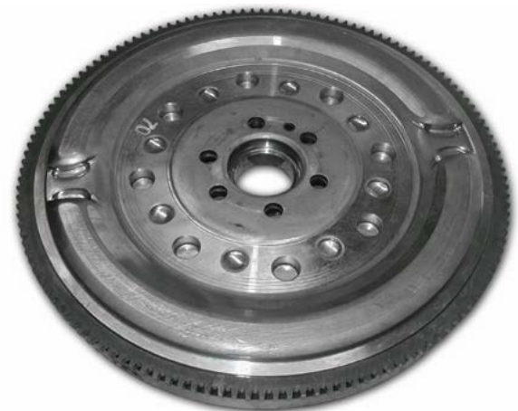
Рисунок 2: Двухмассовый маховик Sachs без кромки на внешнем радиусе
