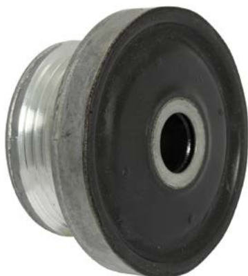
Рисунок 1: Обратная сторона шкива генератора с обгонной муфтой
