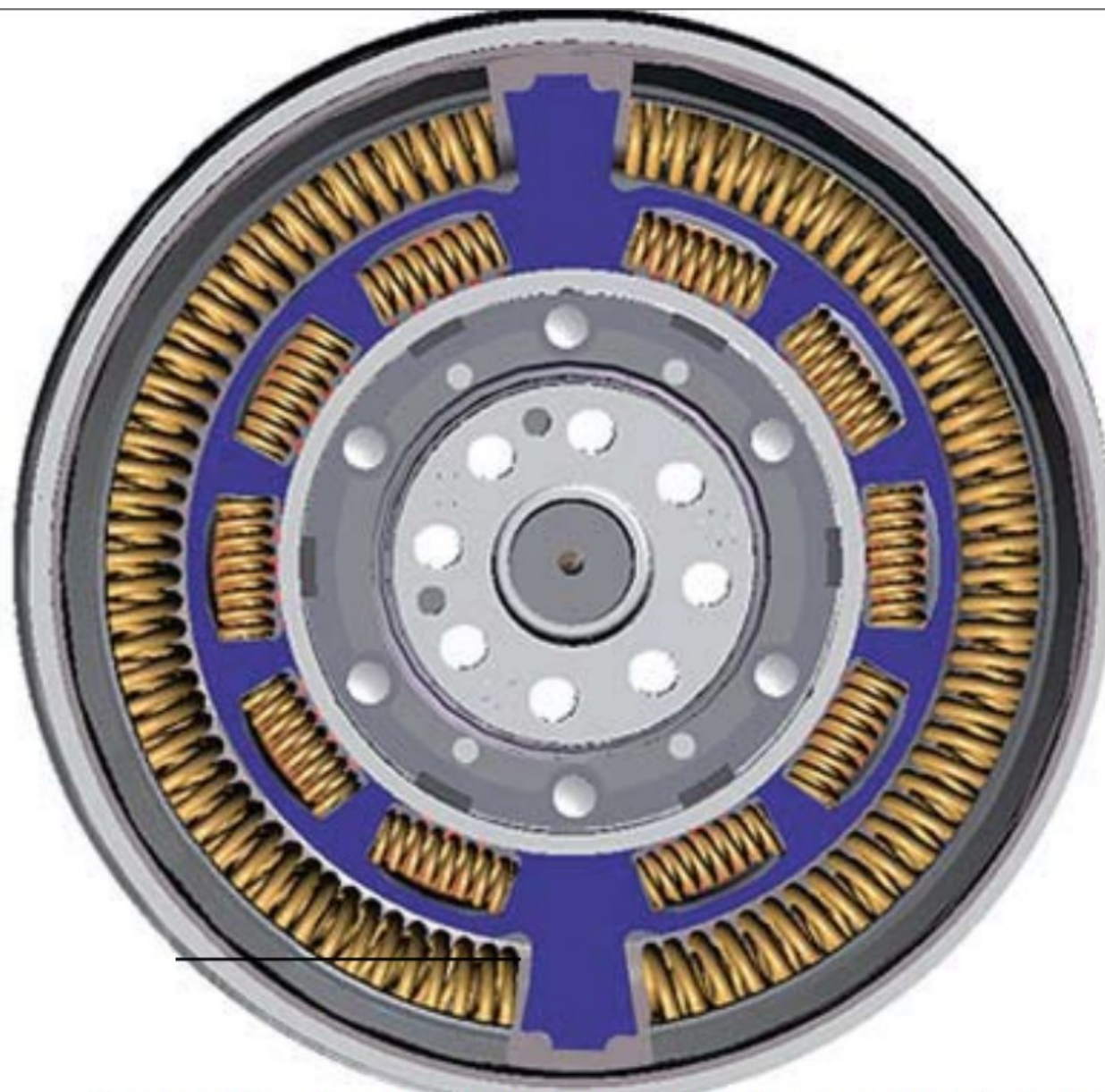
Демпферный механизм двухмассового маховика (синим цветом обозначен фланец который сжимает пружины перемещением по часовой стрелке и против, тем самым сглаживая колебания, вибрации, резкие ускорения и замедления первичной массы относительно вторичной при вращении.)
