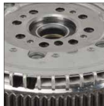
Рисунок 2: Новая конструкция сенсорного кольца
